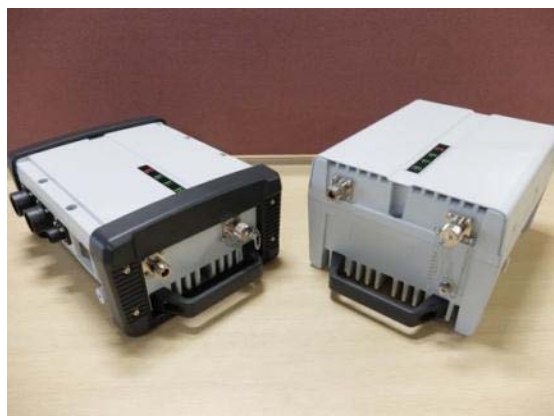
VHF帯無線機
