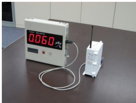
無線機と放射線量測定器との接続例
