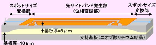
世界で最も低い駆動電圧で1THz帯の高出力光サイドバンドを発生
