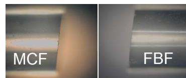
斜め研磨後のキャピラリの側方写真
