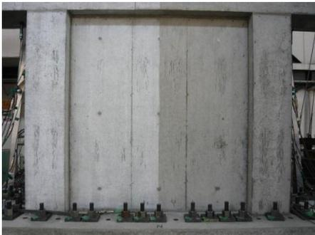
供試体(破壊試験前)
