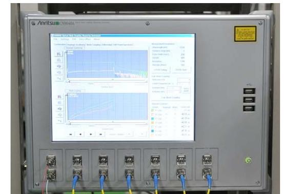
図 モード結合測定装置のプロトタイプ
