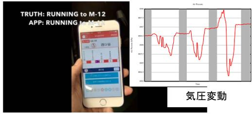
気圧による地下位置推定システム
