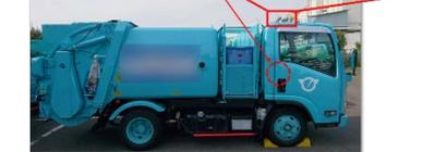
清掃車に設置した音声・モーションセンサによるデータ収集
