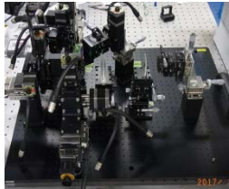
ベンチトップに構築したスイッチ光学系
