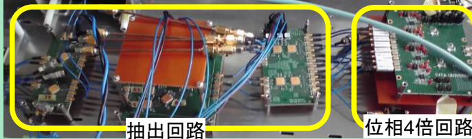
抽出回路 位相4倍回路 Heterodyne検波系と試作した回路
