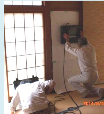
レーダ装置による 壁面走査
