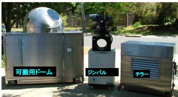
図1 2軸ジンバル(中央)を格納する可搬用ドーム(左)と空 調用テラー(右)
