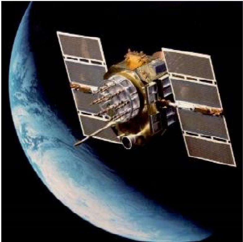
GPS(全地球測位システム)は、24個の衛星を宇宙空間に規則的に配置することにより、地球上のどの位置においても正確な場所を知ることができるシステムです。位置を知る方法として、カーナビなどで一般的に使用されている単独測位と、測地などのより精度が要求される場合に使用される干渉測位の2つの方式があります。
