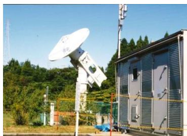
写真-23 2.4mの小型アンテナ。砺波(富山県)、1994年11月。架台は水蒸気ラジオメータの架台を利用した。写真の右側は1992年に導入した車載型コンテナ。可搬型水素メーザとK-4システムの開発により、装置が小型化されコンテナ収納が実現した
