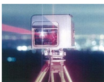
写真-24 スウェーデンAGA社製のジオジメータ8型。1968年から地理院に導入され、光波測距儀の主力機器として、精密測地網測量などに使われた。写真は鹿野山測地観測所の別館屋上で撮影。レーザー光を明瞭にするため、タバコをくゆらした。背景の夜景は、木更津と東京湾を隔てた東京
