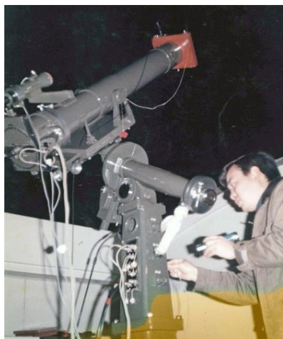
写真-25 GSI 型人工衛星写真赤道儀(鹿野山測地観測所にて。昭和 38 年度配備)。人工衛星(エコーなど)の飛跡を、恒星をバックに写真撮影し、衛星の位置を求めた。本土の観測点と離島などの観測点で同じ衛星を同時に観測し、離島位置の決定などに寄与した。地理院・水路部・東京天文台による共同観測も行われた
