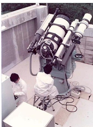
写真-1 鹿野山測地観測所に1976年に設置されたSLR装置(レーザートラッカー)
