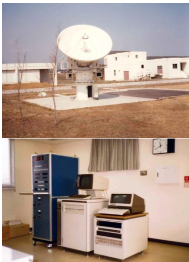
写真-4 地理院構内に設置された 5mアンテナ(上)1982年3月。駆 動操作部(下)は、上写真のアン テナ後方、右側建物内に設置した
