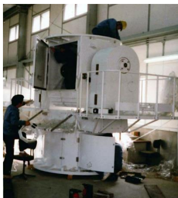
写真-8 明星電気守谷工場内で製作中の5mアンテナ。架台部に部品を取り付けている。海津優らは、製作現場を見学した
