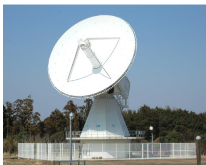
写真-30 茨城県石岡市内に整備中の VGOS 対応 VLBI アンテナ。アンテナ径13.2m。MTメカトロニクス社製(ドイツ)を使用し、東陽テクニカが納入
