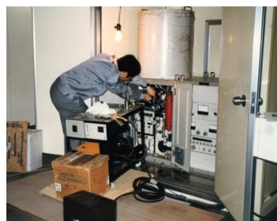
写真-10 天文観測室内で水素メーザを調整するアンリツ社員。水素メーザは両面開きドア付の移動型恒温槽に入っている
