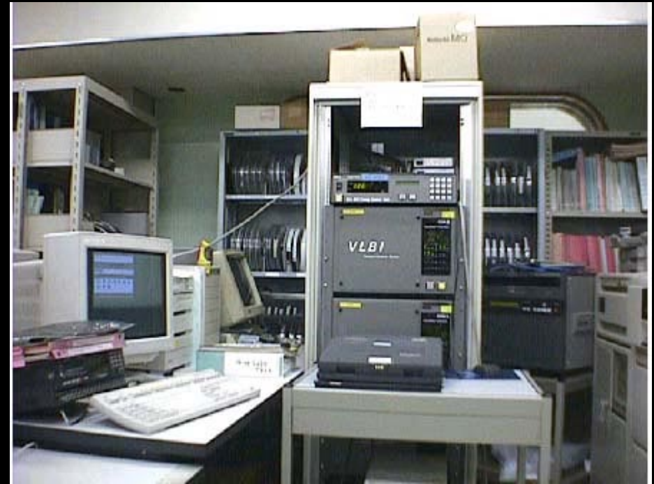
国土地理院様より借用中の簡易型相関器 (実験室データの処理に使用させていただいている)
