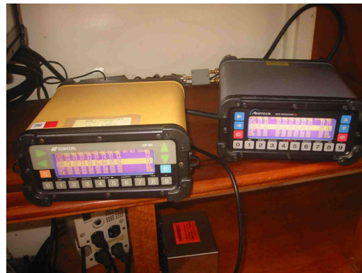
図 5 行政府ビル測量局オフィス会議室内に設置された GPS。左が CRL、そして右がハワイ大学の GPS 受信機 (2つは同機種である)。2 台の受信機の後方にアンテナ分配器が見える。
