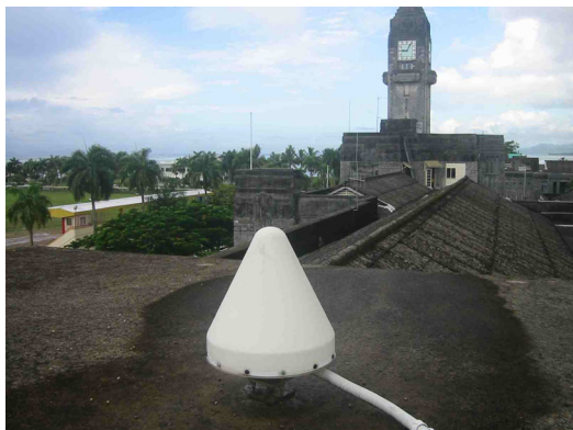
図 6 1997年にハワイ大学が行政府ビル屋上に設置した GPS アンテナ。
