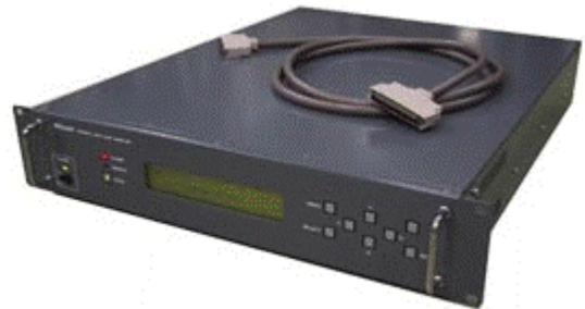
図1 ADS2000 16チャンネル高速ADサンプラー
