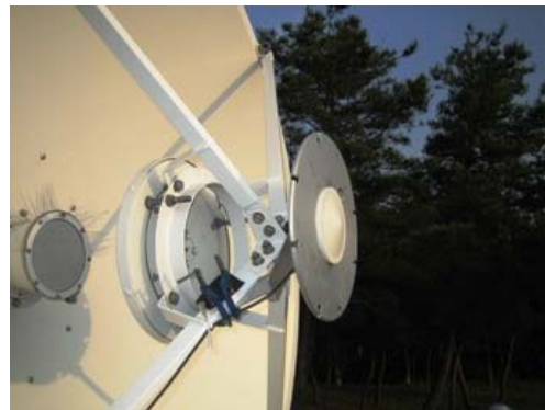
図 3. GPS アンテナを取り付けた様子
