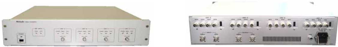
図 2. K5/VSSP32 を 4 ユニット収納したシステム。左は前面、右は背面。
