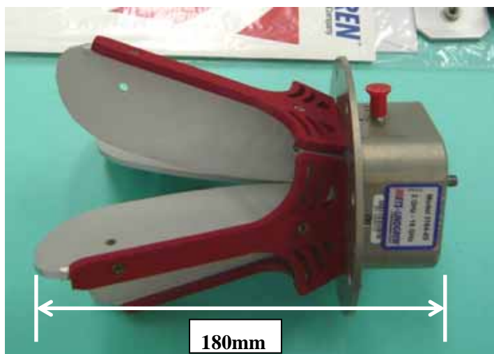
図 1 クワッドリッジホーンアンテナ ETS 社 3164-05 (角すい状外枠の無いタイプ)
