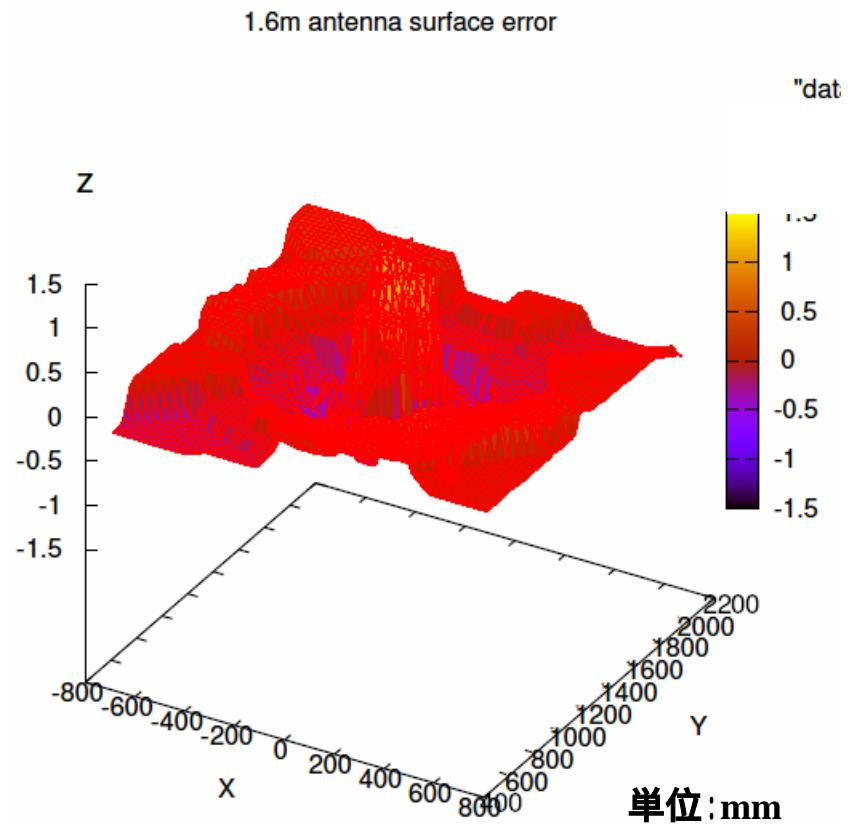
**設計值: 鏡面精度 RMS 1mm,**
