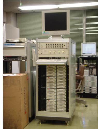
図 2: K5/VSSP32 システム。ラック組込型の PC4 台により最大 1024Mbps のデータレートで記録が可能である。
