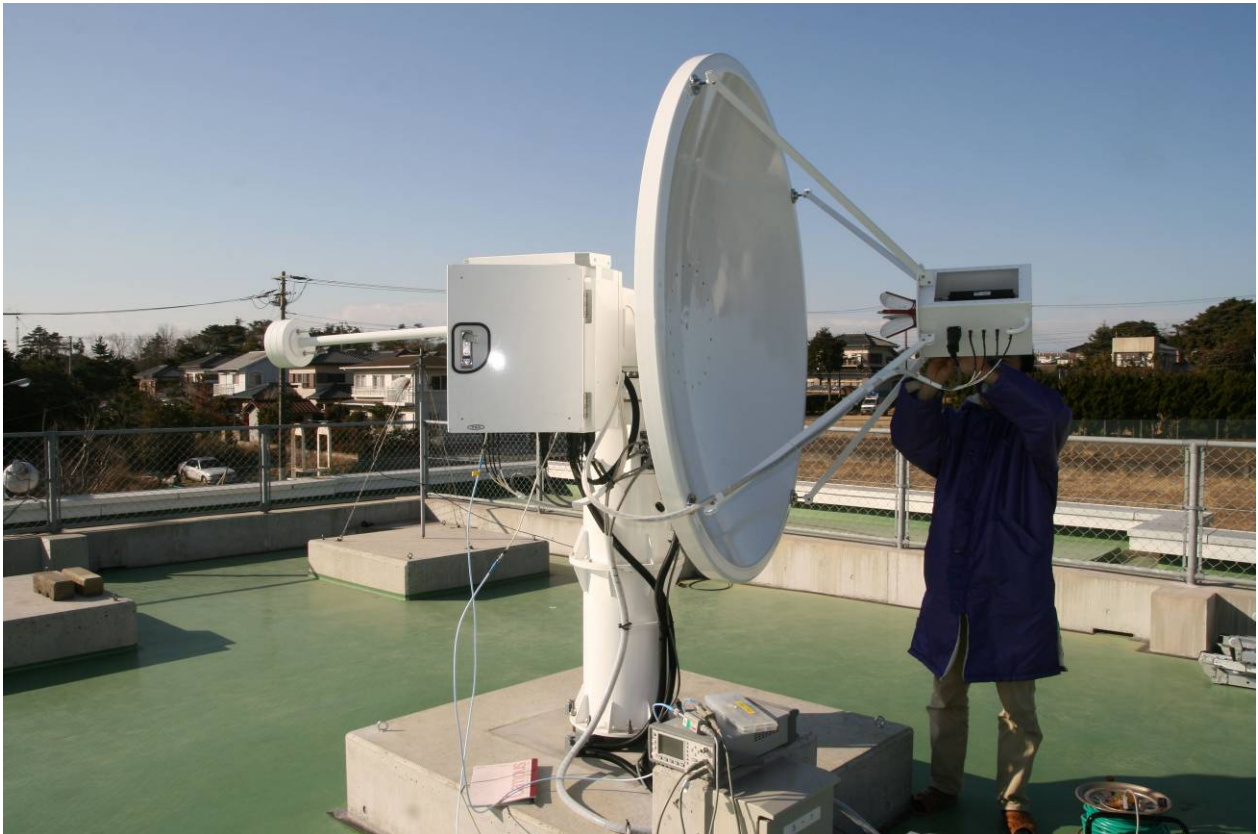
図1 MARBLE超小型VLBIシステム 試作初号機(NICT 鹿島)
