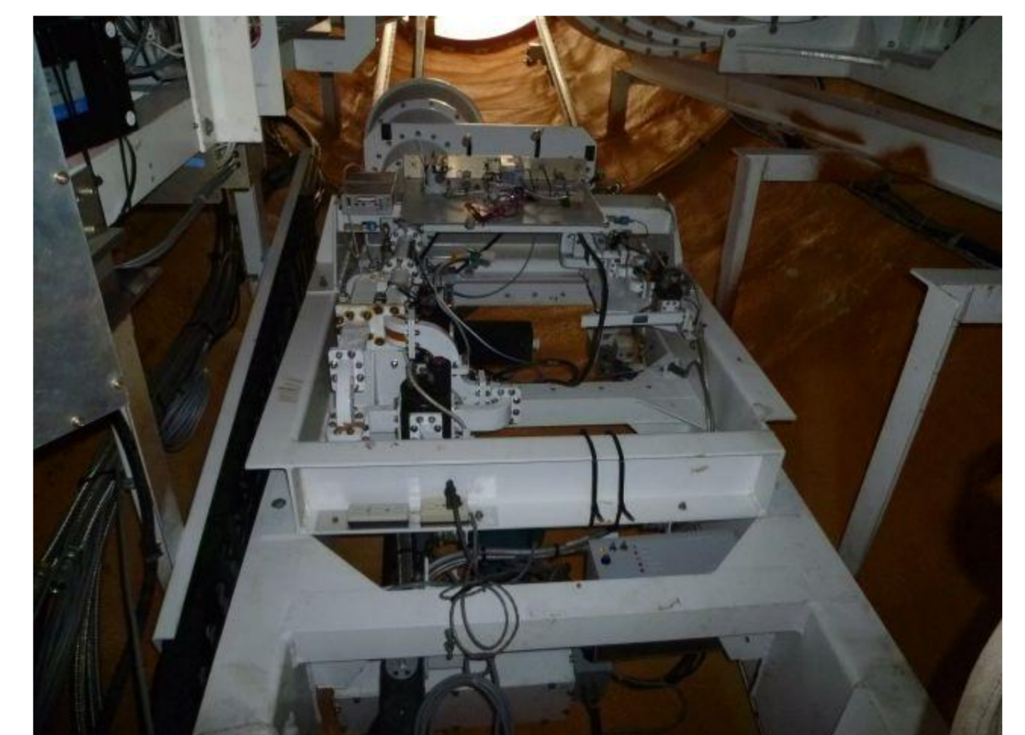
図1 34mアンテナの現Cバンドフィード↑ 開発中のフィードのCAD概略図↓
