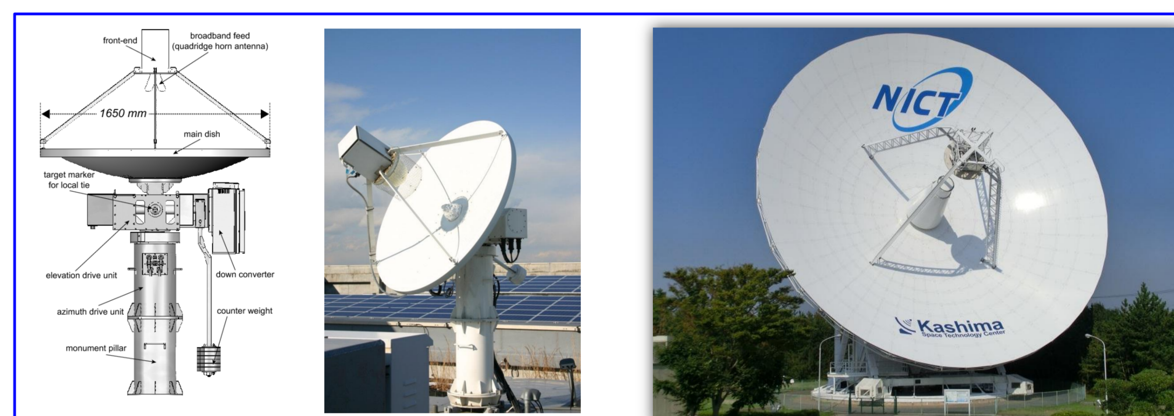
図2 小型VLBIシステムの1.6mアンテナ(左)と鹿島34mアンテナ(右)。小型と大型のアンテナの組み合わせにより受信感度を向上させる。
