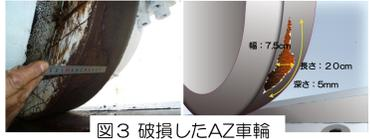
図3 破損したAZ車輪
