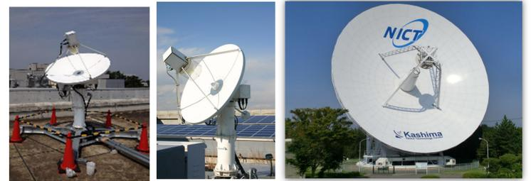
図1 産総研(つくば)に設置した小型アンテナ(左)と、NICT2号館屋上の小型アンテナ(中央)、および小型アンテナの感度をブーストする役割を果たす鹿島34mアンテナ(右)。
