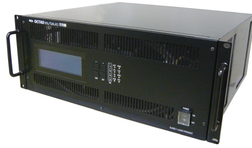
図 4: ダイレクトサンプラ K6/GALAS。16GHz までの周波数域の中から、任意の 1024MHz 帯域幅を 4 バンド同時に取得し、10GEther-SR のポートから VDIF/VTP プロトコルでデータを出力する。
