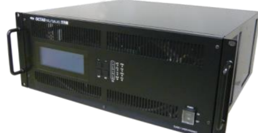
図4 RFダイレクトサンプリングに使用する高速サンプリングK6/GALAS。
