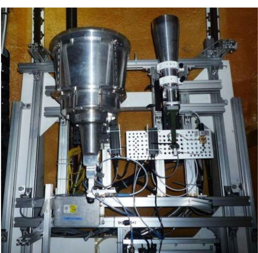
図3 34mアンテナに設置されたNINJAフィード(左)とIGUANA-Hフィード(右)。
