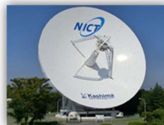
図 2: 産総研(つくば)に設置した小型アンテナ(上左)と、NICT2 号館屋上の小型アンテナ(上右)、および小型アンテナの感度をブーストする役割を果たす鹿島 34m アンテナ(下)。
