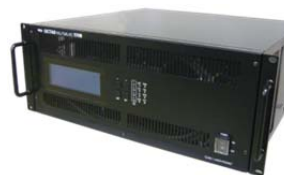
図 4: RF ダイレクトサンプリングに使用する高速サンプラ K6/GALAS。
