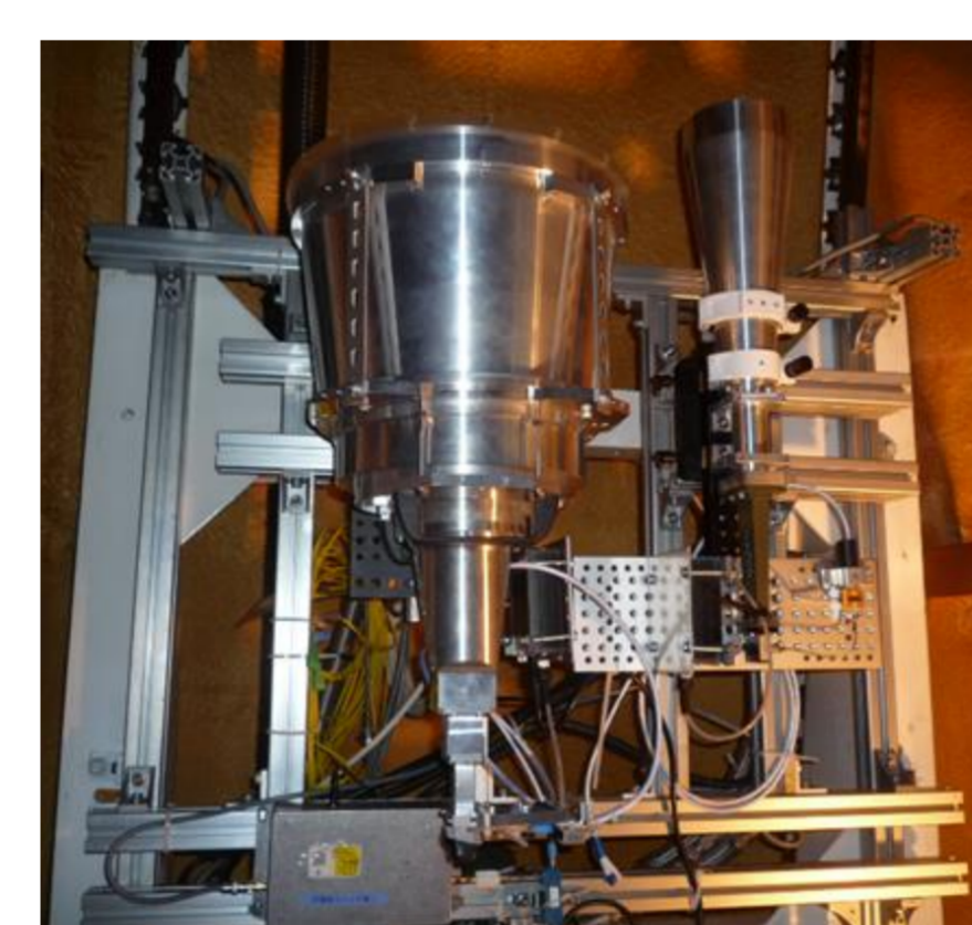
図2 34mアンテナに設置されたNINJAフィード(左)とIGUANA-Hフィード(右)。
