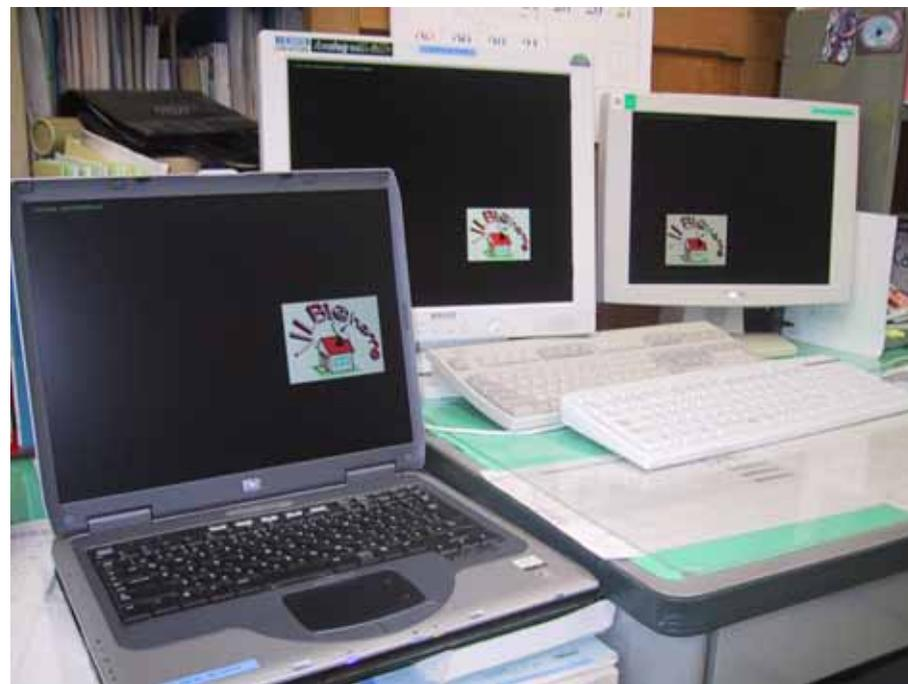
スクリーンセーバ型関連プログラムにより3台の汎用PCで分散処理を行っている図
