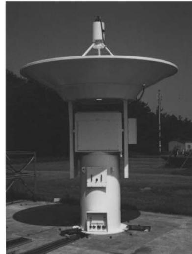
図1 超小型V L B Iシステム3mアンテナ
