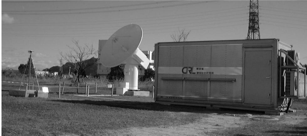
図2 岐阜大学構内に設置した超小型VLBIシステムとGPSアンテナ（左）
