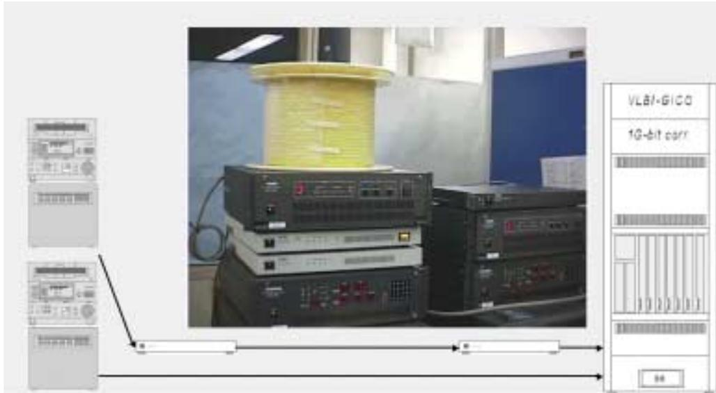
(図 4. 関連処理系に伝送装置を組み込んでおこなった関連処理。機器上のドラムが光ファイバ)
