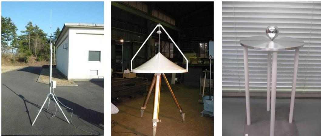
図4 ディスクコーンアンテナ(左)、曲面反射鏡アンテナ(中央)、涙滴型モノポールアンテナ(右)
