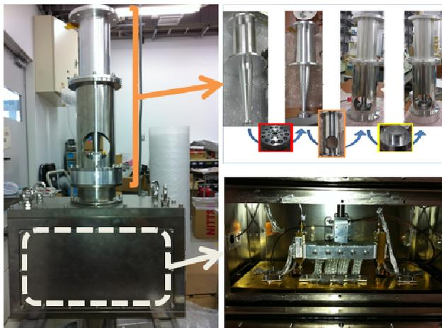
fig.1 22GHz 受信機外観（左、右）と上部構造（右上）
