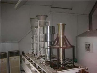
上海望遠鏡に搭載した 6.7GHz 帯受信機の写真
