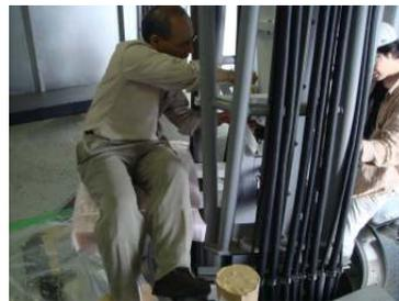
茨城局(高萩、日立)において、6.7-8GHz 帯広帯域受信機の開発協力を進めている。左上図は冷却 Dewar の写真であり、中央に円偏波分離器が写されている。右上図は、この受信機の搭載試験の様子を示す。
