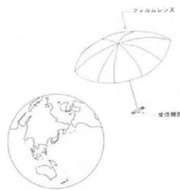
1000倍(集光力は10<sup>4</sup>倍)も大きな1km級望遠鏡を作ることを目指しています。21世紀の電波天文学、特に大望遠鏡による高分解能・大集光力観測を切り拓いていくのはレンズ方式です。
