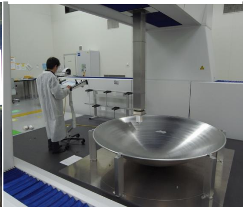
図4：クリスタル光学(京都)で測定。曲面の測定ソフトがなく、セット含め一日。1.8m鏡1600点測定に6時間。
