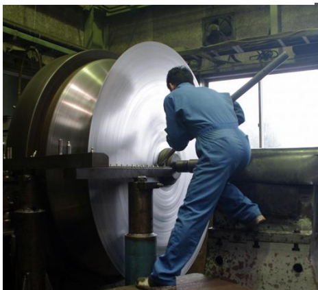
図3：北嶋絞り製作所での口径1.8mアンテナの加工。所用1時間程度。厚3ミリ全重量20kgのアルミ板。
