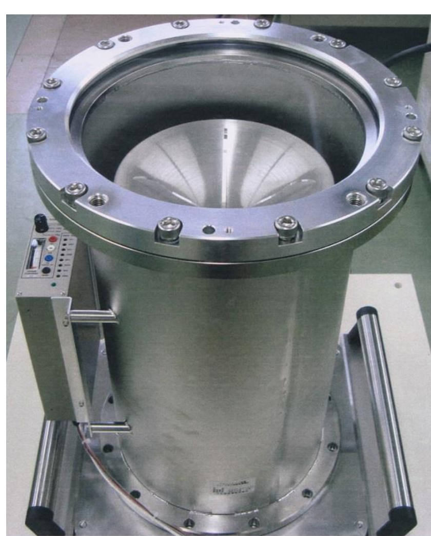
写真1 QRFH(2-14 GHz) in cryogenic dewar Feed &amp; LNA
