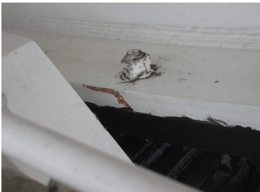
写真1 セクターギヤに残された衝撃打痕
