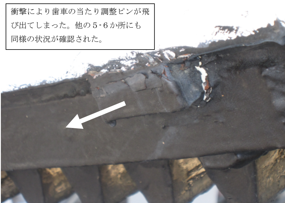
写真2 歯当たり調整ピンの抜け（全部で5ヶ所）
