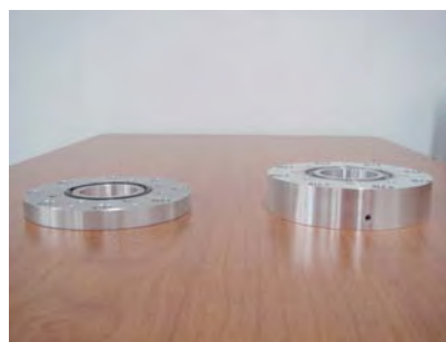
図2. (左) 従来のフランジ (右) 改造後のフランジ
