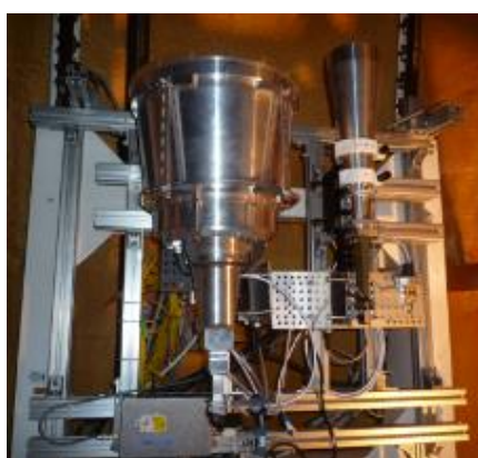
34m アンテナに設置した広帯域フィードと常温 LNA(左写真)
