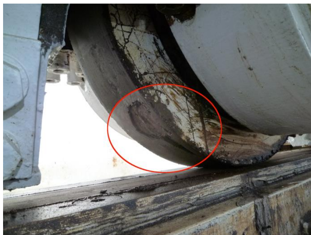
写真1 損傷を受けた交換前の車輪
