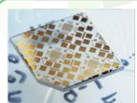
酸化ガリウムトランジスタ、ダイオードを作製したチップ
