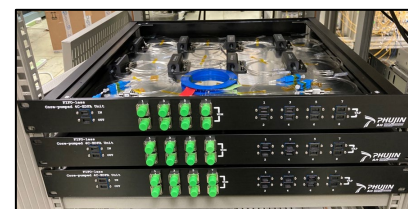
図3.2.1 FIFOレスMCF光中継器(左)及び構成デバイス(右)
