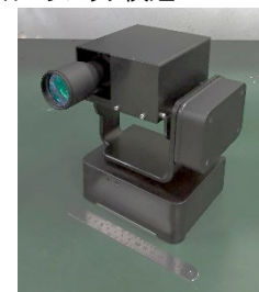
図1-b-3：③RoFSO光 ターミナル試作結果
