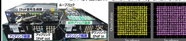
図1-b-1：①AD協調回路のループバック検証
