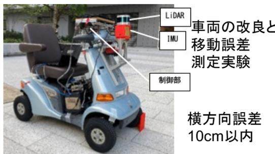
車両の改良と移動誤差測定実験
