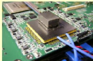
開発した電気パラレル-光シリアル変換器の外観
