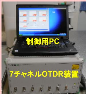
試作したマルチチャンネルOTDR装置
