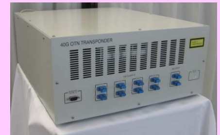
波長分散推定機能を実装した40Gbpsリアルタイムデジタル信号処理回路装置の実現成果④・⑤ (課題イ-2-3, 4と連携)
